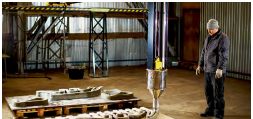
Первый в Вологодской области 3D-принтер, печатающий бетонными смесями, может создавать огромный спектр как малых архитектурных форм, так и серьезных строительных конструкций.
